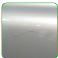
Repor kortare än 10 mm som kan poleras bort.
