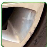
Mindre kantskador högst 30 mm utan sprickor.
