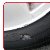
Skador som äventyrar däckets funktion.
