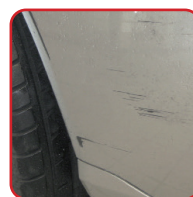
Lackskador ner till underliggande plåt eller plast.
